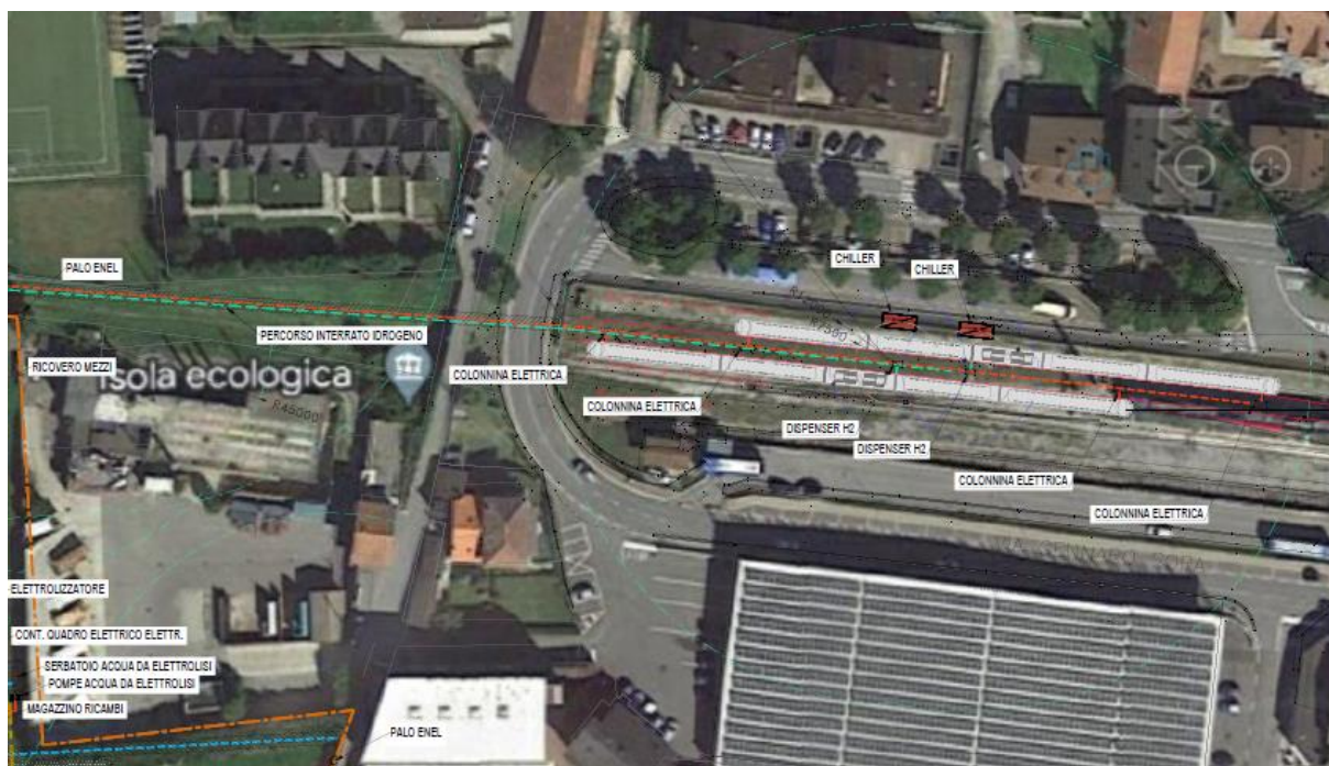
FIGURA 2 AREA D'INTERVENTO: STATO DI PROGETTO PER IL LOTTO FERROVIARIO, DI EROGAZIONE (PER TRENI)
