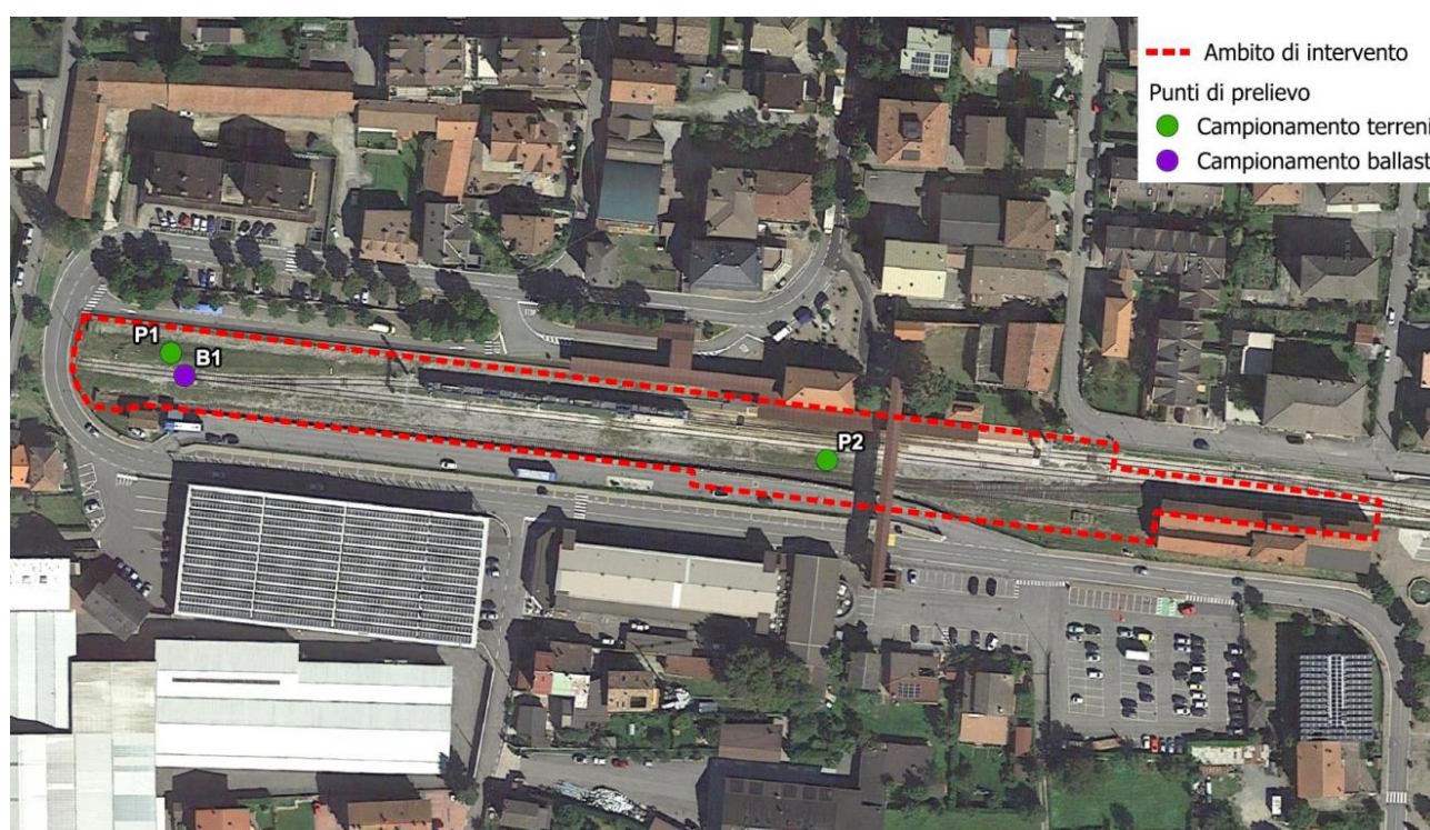
Figura 6-1: Ubicazione dei punti di indagine per i terreni di scavo (P1 e P2) e per il ballast (B1)
