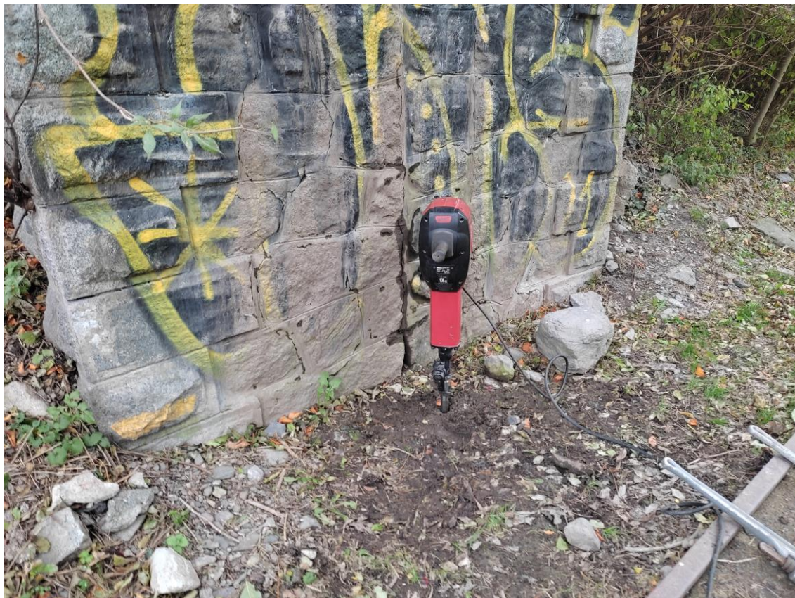
Figura 33 foto infissione asta con martello pneumatico
