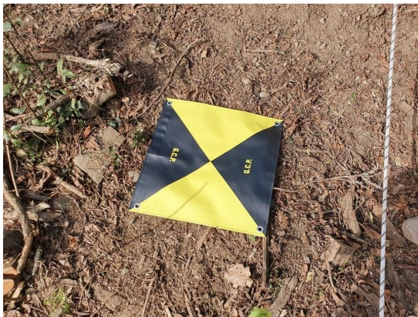
Figura 12 Esempio di marker artificiale posizionato a terra
