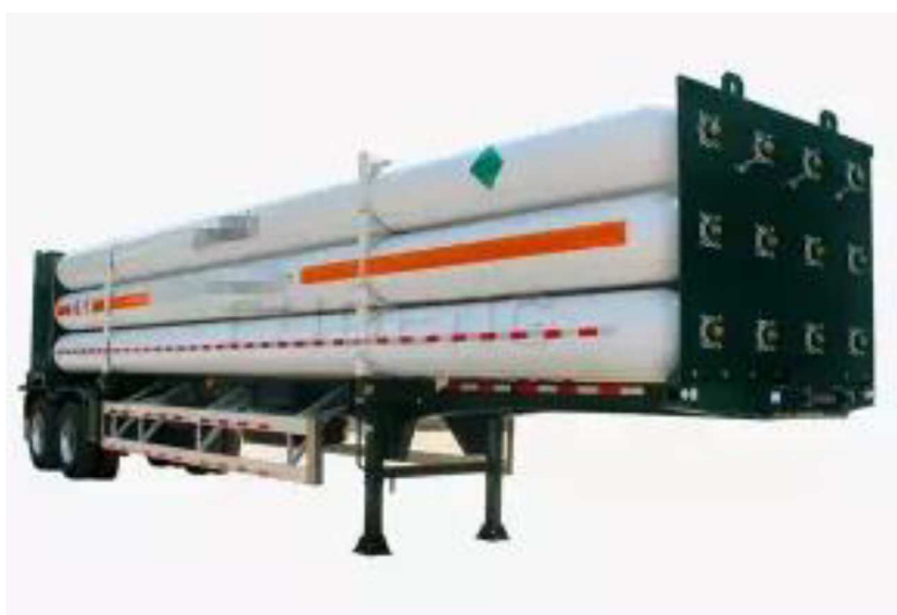
Figura 10 – Rappresentazione tipologica di carro bombolaio
