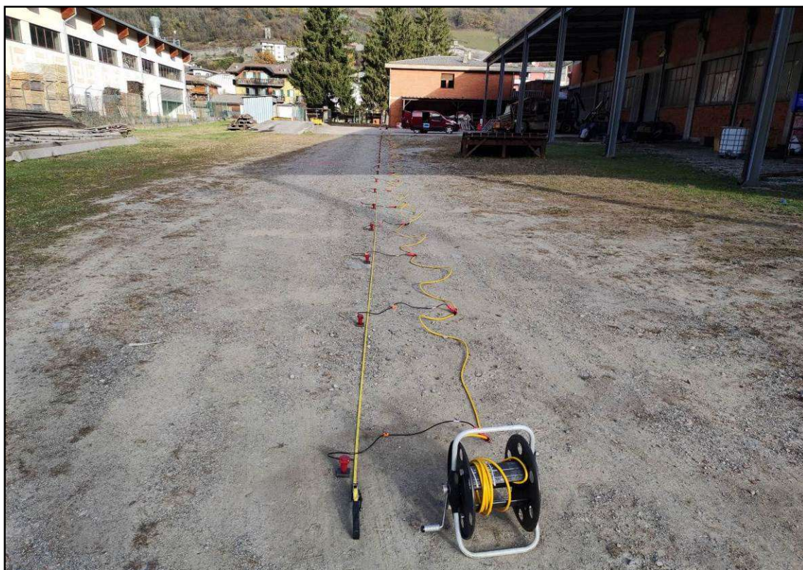
Figura 6 Vista dello stendimento MASW M1
