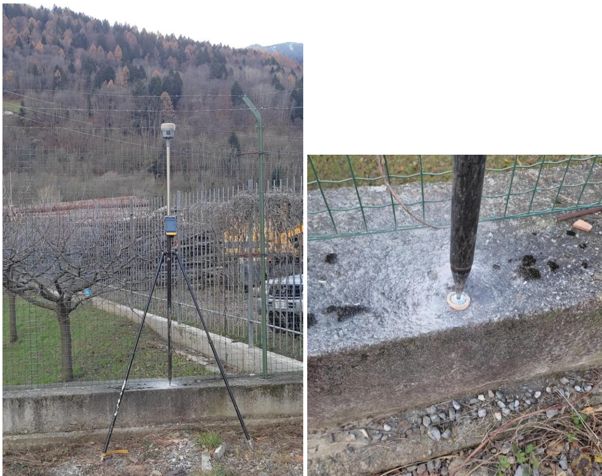
Figura 2 Caposaldo 201 materializzato
