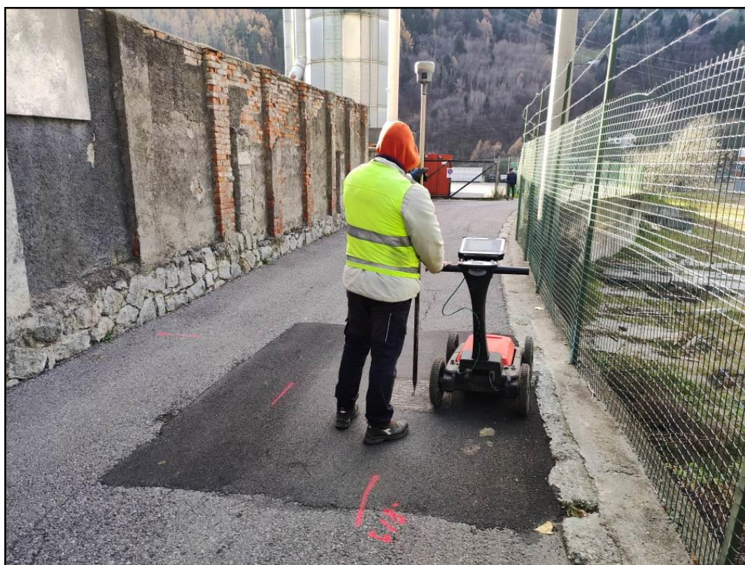
Figura 30 Rilievo GPS dei sottoservizi rilevati don GPR
