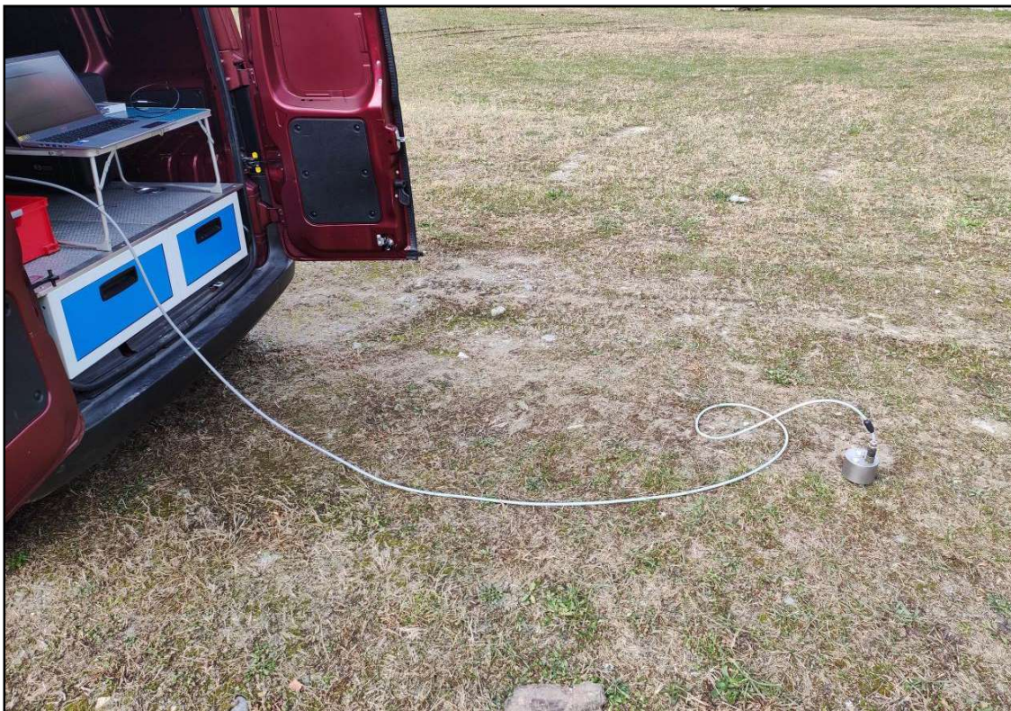
Figura 3 vista della strumentazione utilizzata per la misura di microtremore HV1
