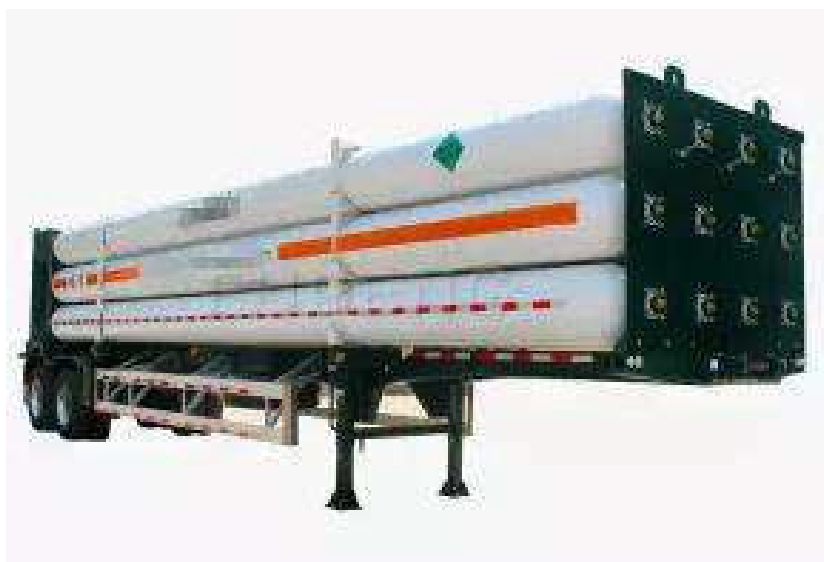
Figura 9 - Rappresentazione tipologica di carro bombolaio
