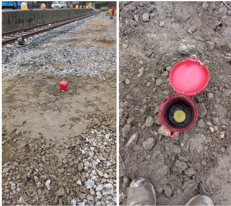
Figura 13 – Particolari del chiusino metallico a protezione del tubo piezometrico.
