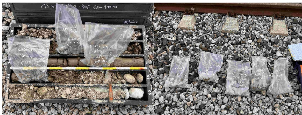
Figura 10 – Prelievo di campioni “rimaneggiati” per analisi di laboratorio.
