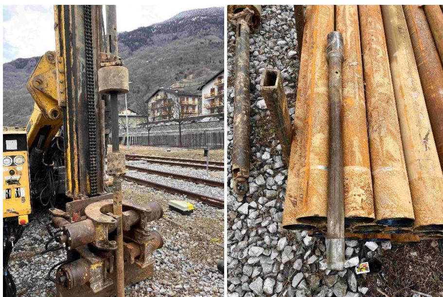
Figura 8 – Prova penetrometrica in foro tipo SPT. Esecuzione prove (Sx) e Campionatore RAYMOND (Dx).
