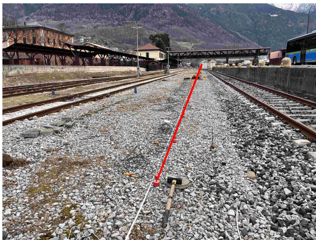
Figura 15 – Stendimento MASW-01 realizzato, con orientazione circa E-O, a partire dal foro di sondaggio S-01, parallelamente al binario N°3 (tratto morto) presente all'estremità sud della stazione ferroviaria.
