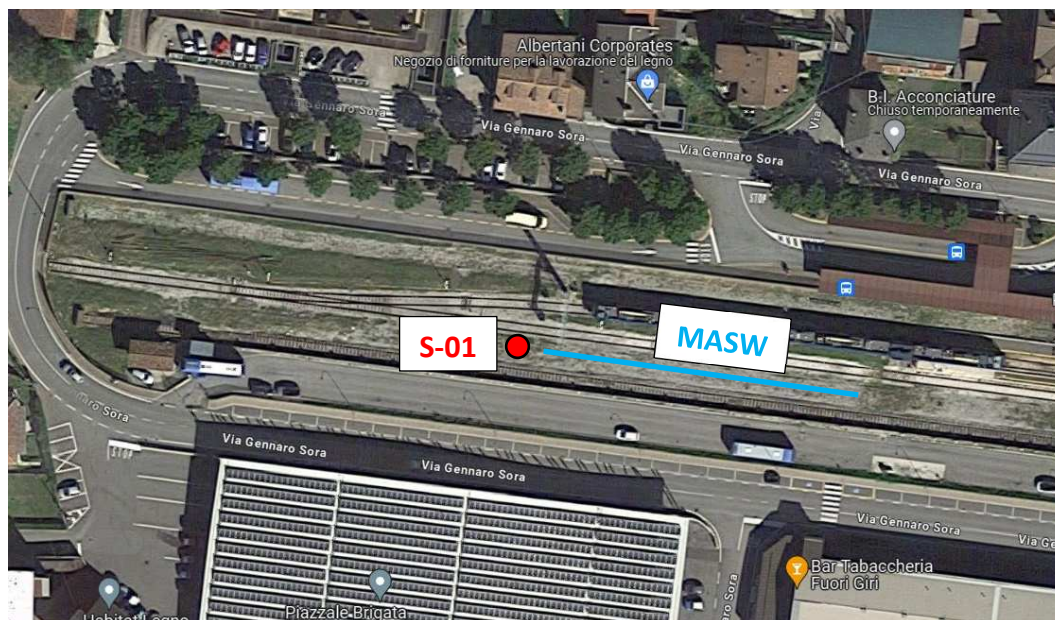
Figura 2 – Ubicazione delle indagini geognostiche eseguite (su immagine Google Maps). In rosso l'ubicazione del sondaggio a carotaggio continuo e in azzurro lo stendimento di sismica a rifrazione tipo MASW.
