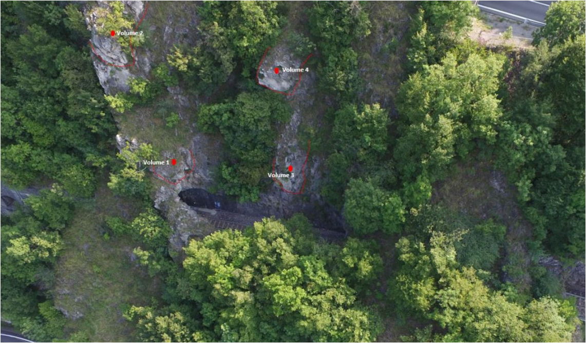
Foto 2 Panoramica di dettaglio e inquadramento dei volumi potenzialmente instabili
