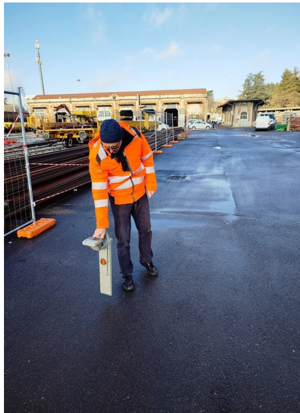
Completamento delle indagini mediante utilizzo di Radiodetection (Rilevatore elettromagnetico di sottoservizi e cavidotti in tensione)
