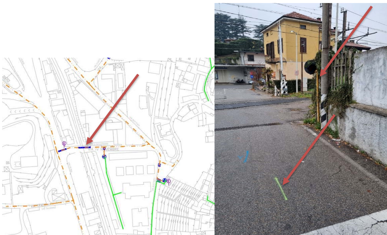
Stralcio cartografia Società impianti metano Via VI Novembre e foto posizione impianto rilevato e sfiato interferente
