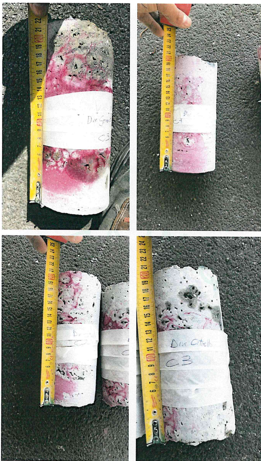
Foto 7-12: esempi di misurazione della carbonatazione
