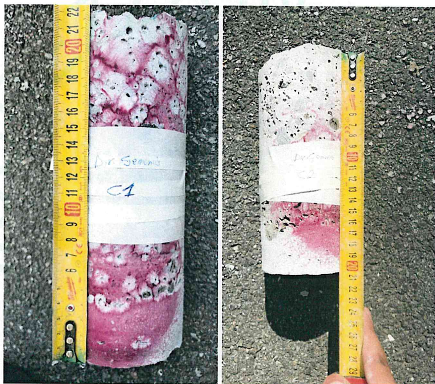
Foto 1-6: esempi di prelievo campioni attraverso carotaggio
