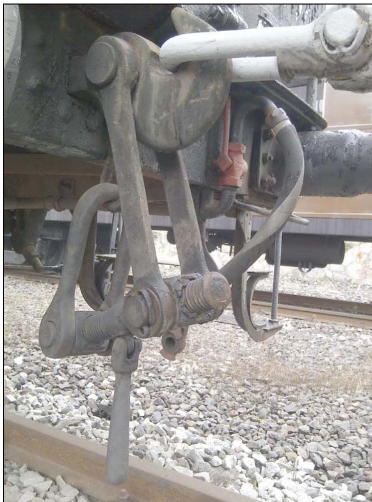
Figura 2 Tenditore a vite in posizione di riposo.
