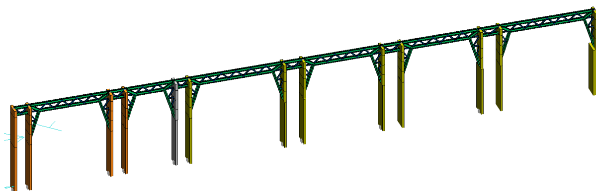
Figura 9 – Strutture di controventamento in acciaio – direzione trasversale all'asse dei binari
