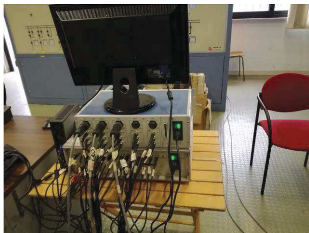
Foto 7 Data logger dinamico (Sistema di acquisizione digitale)
