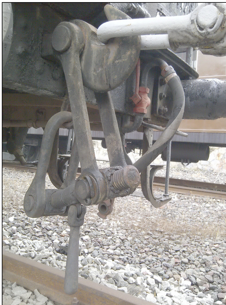
Figura 2 Tenditore a vite in posizione di riposo.
